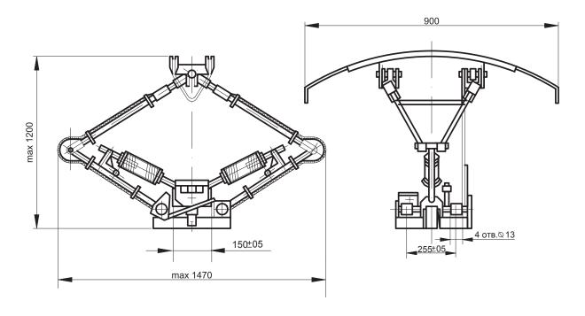
Рис. 42. Габаритные и установочные размеры токоприемника рудничного типа ТРН-М
